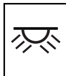
Beleuchtung Mannschafts- raum
