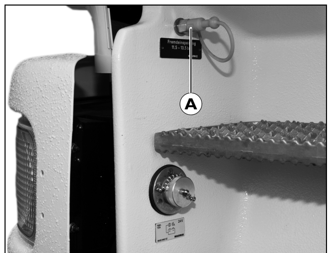
[36] Einspeisekupplung zur Druckluft-Fremdeinspeisung
