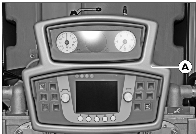
[257] Einbauort der elektropneumatischen Ventile für die Notbedienung (Ausführung kann von der Darstellung abweichen) im Löschfahrzeug mit Wassertankvolumen < 1200 l
