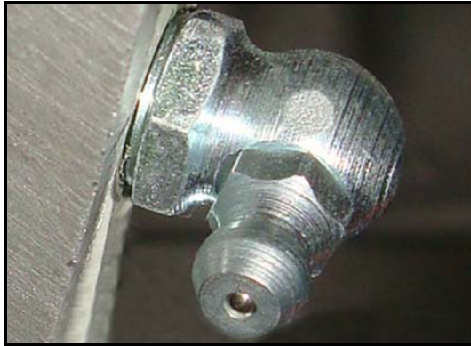
Schmiernippel der Pumpe
