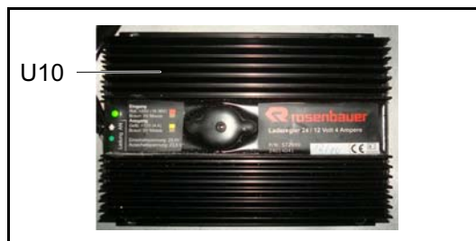
U10 Spannungswandler von 24 Volt auf 12 Volt
