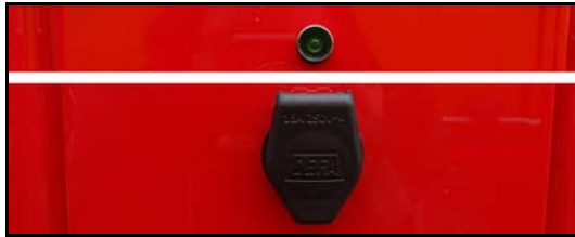
Kontrollleuchte und Einspeisanschluss für 230 Volt
